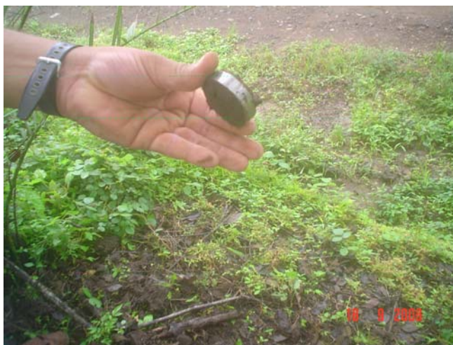
Fotografía 5.4 - Anillo de muestreo con la muestra contenida en él para el análisis de la capacidad de campo y del punto de marchitez.
